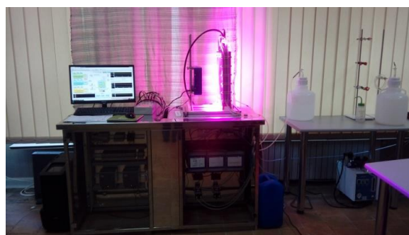
Fig. 16. Fotobioreactor în regim de lucru a - Sistemul de iluminare oprit; b - pornit
